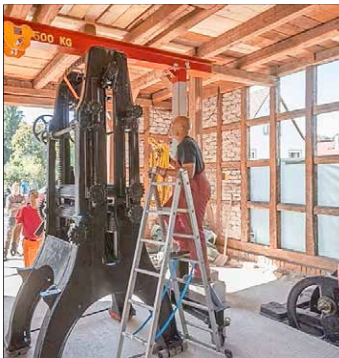
Mit Hilfe eines Portalkranes, Schwerlastrollen und Muskelkraft wurden zuerst das Sägegatter und das Schwungrad in der Ausstellungs-scheune positioniert
